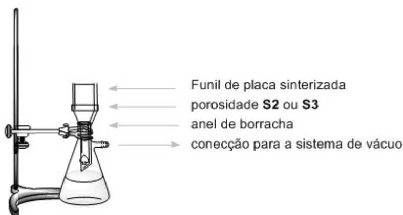
Figura 3. Esquema da montagem para a filtração por sucção.
